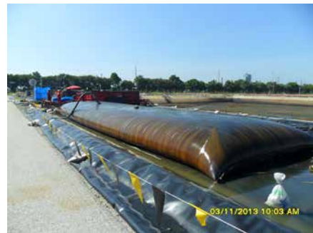
การใช้ถุง “จีโอ แบ็ก” เพื่อลดปริมาณตะกอนจากกระบวนการบำบัดน้ำเสียชีวภาพ
